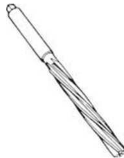
Escariador <12 mm) guía 09916-44.511 Válvula
