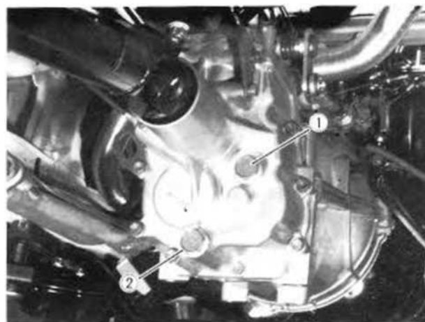
1. Tapón de llenado de aceite 2. Tapón de vaciado de aceite
